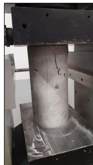
**Figura 3:** Ensaio de resistência à compressão.
